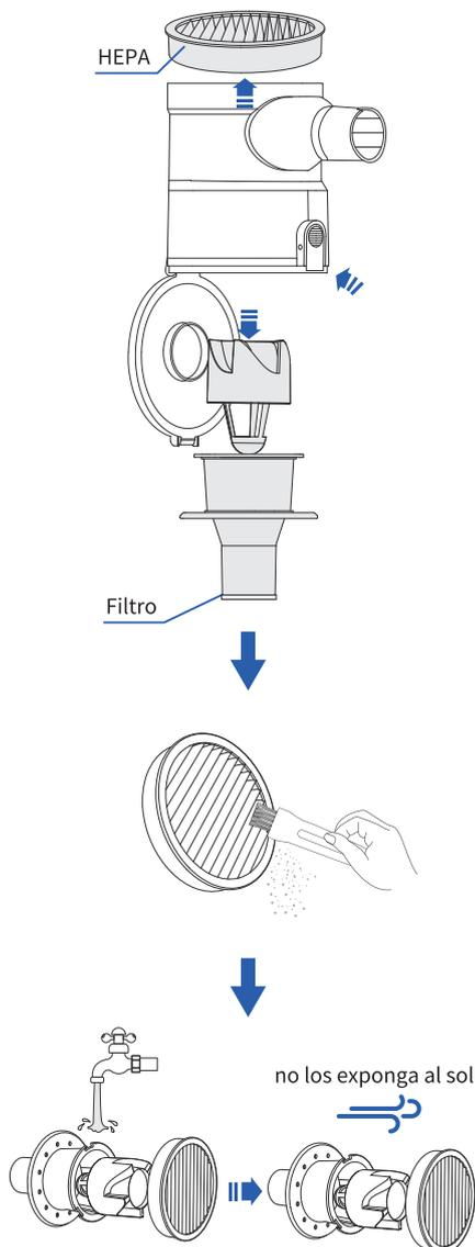
**Advertencia:** ¡No utilice esta máquina si el filtro y los componentes HEPA no están instalados! No utilice el filtro y los componentes HEPA hasta que estén completamente secos después del lavado.
