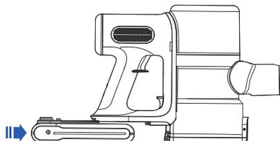
**Rimozione:** premere il pulsante di rilascio della batteria ed estrarla.
