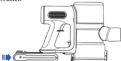
**Ausbau:** Drücken Sie die Taste zur Akkuentriegelung und ziehen Sie den Akku heraus.
