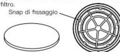
3. Tenere il gruppo HEPA con la fune rivolta verso l'alto e inserire il gruppo HEPA nel contenitore della polvere dalla parte superiore. Notare che la baionetta limite del gruppo HEPA deve essere allineata con la barra limite del contenitore della polvere.
