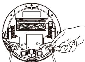
**4. Portare l'interruttore alla base dell'aspirapolvere robot in posizione di accensione (1 indica accensione, 0 indica spegnimento).**
