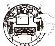
2. Per pulire completamente la spazzola a rullo, rimuovere i peli e capelli con il raschietto in dotazione.
