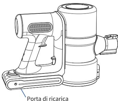
2. Come mostrato in figura, dopo aver rimosso la batteria inserire la spina di ricarica nella porta di ricarica della batteria, la spia lampeggerà di blu a indicare che è in carica. La spia si illuminerà di luce blu fissa al termine della carica.
