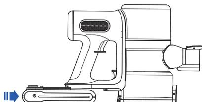
取外: 電池隙間ボタンを押して外向きに引き出すと、電池を取り外すことができます
