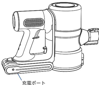
方式2: 図示のように、電池を取り外した後、充電アダプタを電池の充電ポートに挿入します。充電中: 表示灯が青点滅; 充電満: 青常時点灯。
