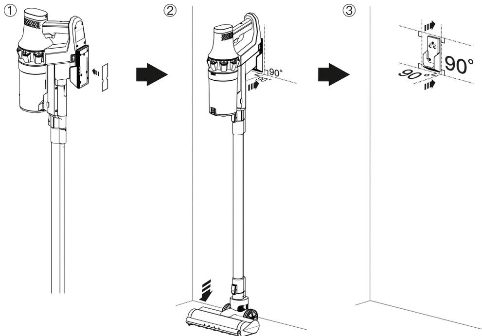
Método 2: instalación de tornillo
