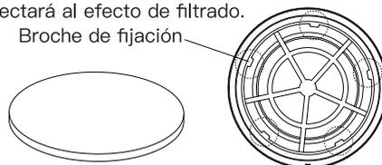
3. Mantén el ensamblaje HEPA con la cuerda hacia arriba, y coloca el ensamblaje HEPA en el contenedor de polvo desde la parte superior del contenedor de polvo. Se debe tener en cuenta que la bayoneta límite del conjunto HEPA debe estar alineada con la barra límite del contenedor de polvo.
